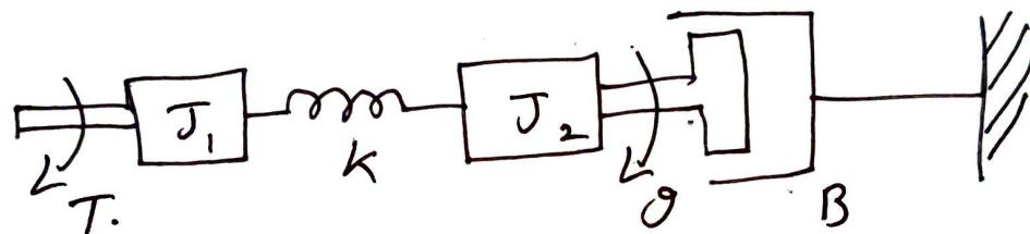
$$i/p \quad T \xrightarrow{2T} T(s) \quad T_{\text{ofind}}: \frac{\theta(s)}{T(s)}$$
